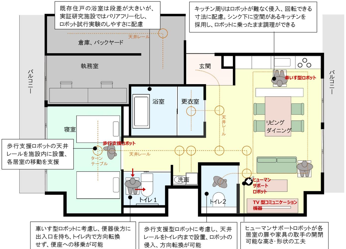
図：ロボティックスマートホーム平面図
